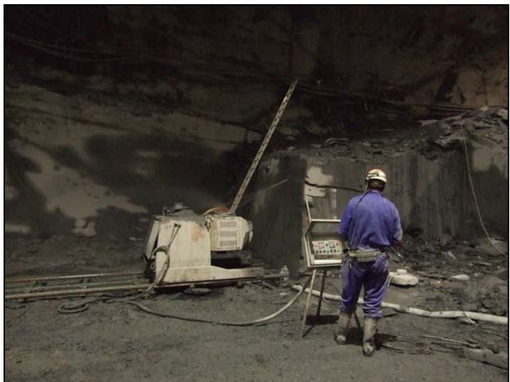
Fotografía 4.2.6.13.5.- Arranque mediante corte con hilo en una mina subterránea de pizarras. jfs
