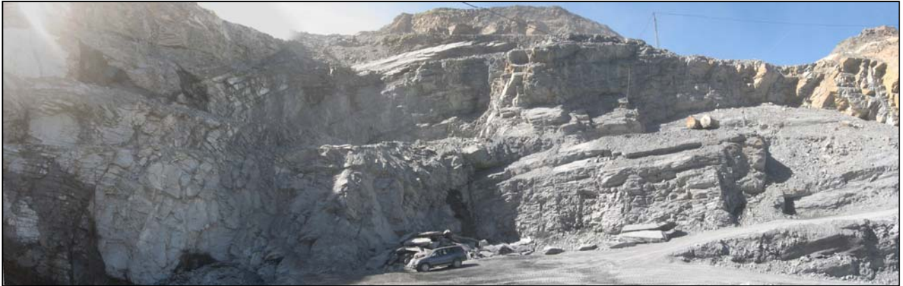
Fotografía 4.2.6.10.3.- Cantera Juanita en los bancos superiores, donde se observa el fuerte plegamiento de las capas cuarcíticas del recubrimiento. afa
