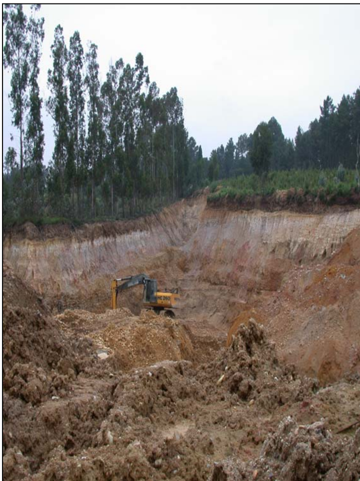
Fotografía 4.4.1.1.2.- Explotación de arcillas en una terraza del río Miño. afa
