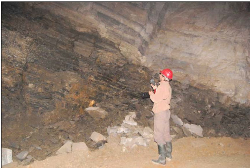
Fotografía 4.4.5.3.- Capas ricas en magnesita dentro de las galerías de explotación de la empresa Magnesitas de Rubián, S. A. jmf
