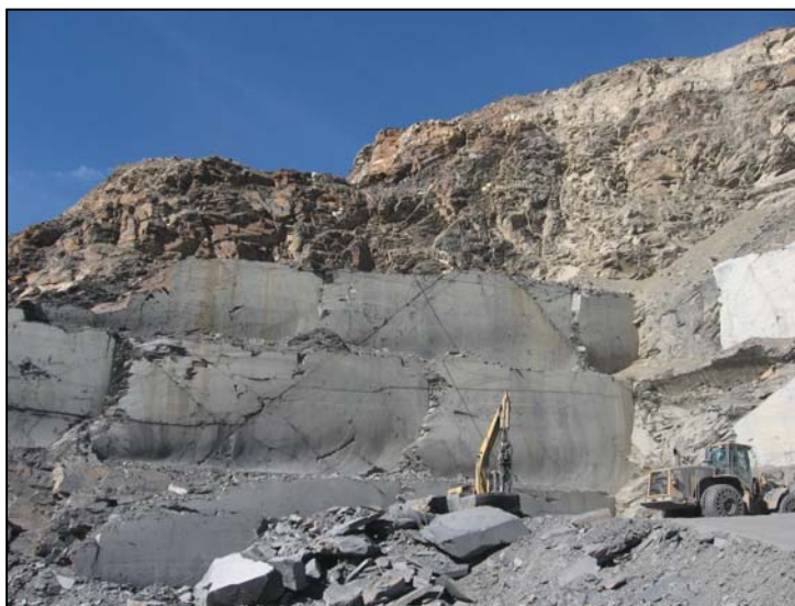
Fotografía 4.2.6.11.5.- Recubrimiento y capa útil indicada por los cortes con hilo del frente. Cantera Vianzola. afa
