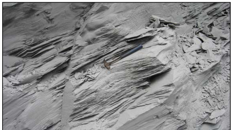
Fotografía 4.2.6.8.2.- Detalle de las pizarras en el frente de explotación de Lamas-Vilarchao. afa
