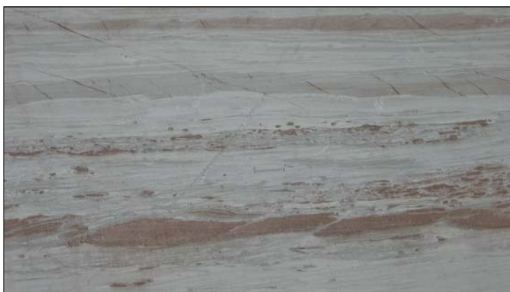
Fotografía 4.2.6.3.7.- Intensa deformación en pizarras medias con laminaciones del sector de Xemil. afa
