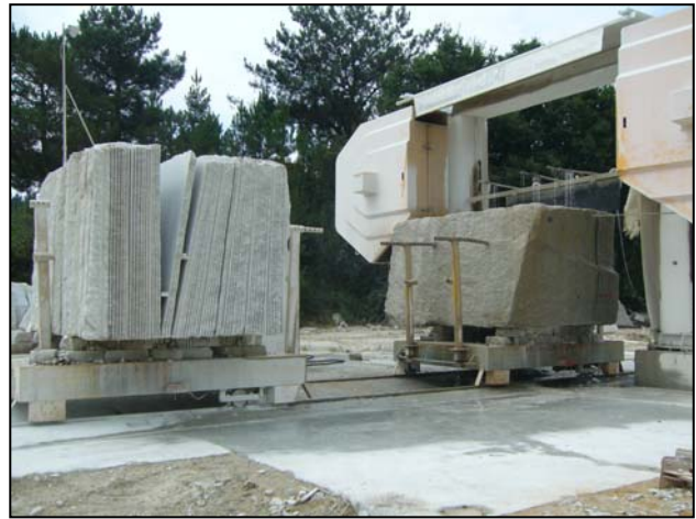
Fotografía 4.2.5.3.9.- Corte del bloque en planta con hilo diamantado. jfs.
