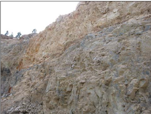
Fotografía 4.4.4.3.- Zona de albitita alterada en la parte alta del frente, sobre la albitita fresca. afa
