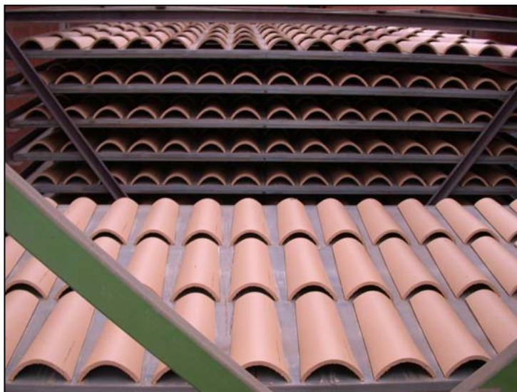
Fotografía 4.4.1.4.2. – Vagonetas con tejas durante fabricación en la empresa Cerámicas Verea.jfs
