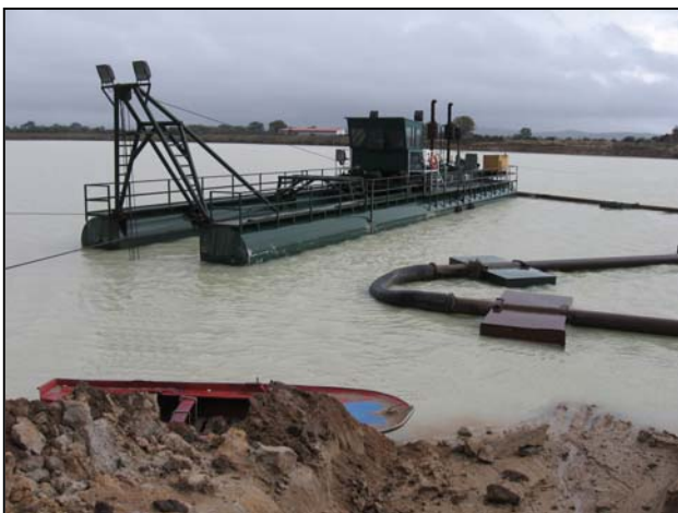
Fotografía 4.3.1.1.4.- Draga y noria de lavado para la obtención de arenas bajo el nivel freático en Xinzo de Limia. afa
