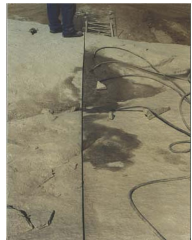
Fotografía 4.2.5.3.4.- Corte en cantera con hilo diamantado y detalles del corte con lanza térmica e hilo. afa
