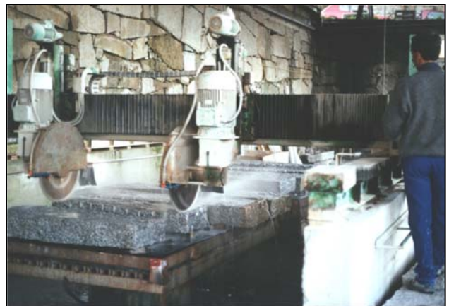
Fotografía 4.2.5.3.12.- Cortes transversales en una sierra puente. afa
