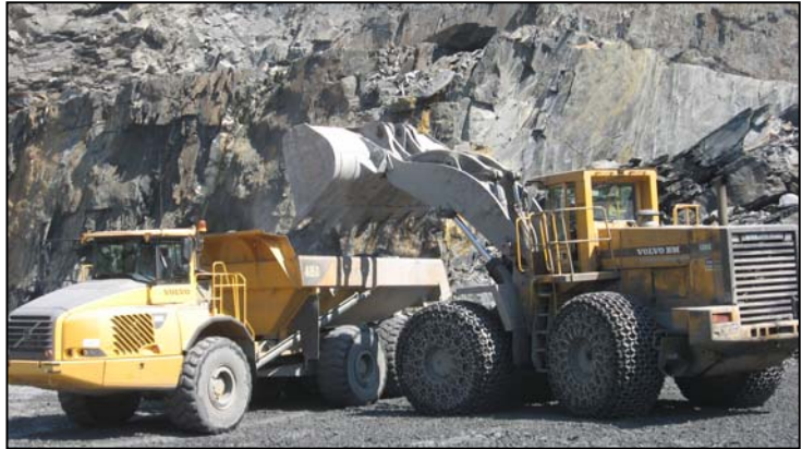
Fotografía 4.2.6.13.4.- Carga de escombros con destino a escombrera. afa
