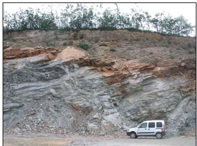
Fotografía 4.3.2.5.4.- Vista de uno de los bancos de explotación de esquistos en Reboira. jfs
