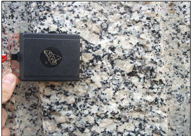
Fotografía 4.2.5.1.15.- Detalle textural del granito Gris Perla ( Facies externa del Macizo de Caldas de Reis). vga
