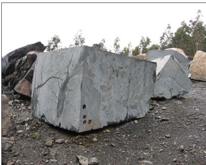
Fotografía 4.2.8.1.-: Bloques heterométricos y detalle de un bloque de serpentinita con estructura nodulosa.
