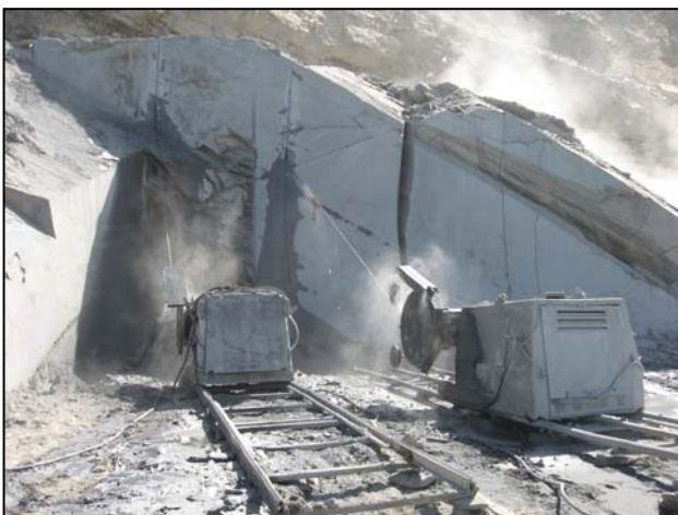
Fotografía 4.2.6.13.3.- Corte con hilo en pizarras y detalle. afa
