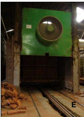
Fotografías 4.4.1.4.1.- A- Entrada del material al molino. B- Acopio de material en los pudrideros. C- Fabricación y corte de ladrillos. D- Vagonetas con ladrillos, previo a la cocción. E- Compuerta de entrada de las vagonetas. F- Plástico de los palés de ladrillos. G- Almacén de palets en una nave para su posterior distribución. jfs
