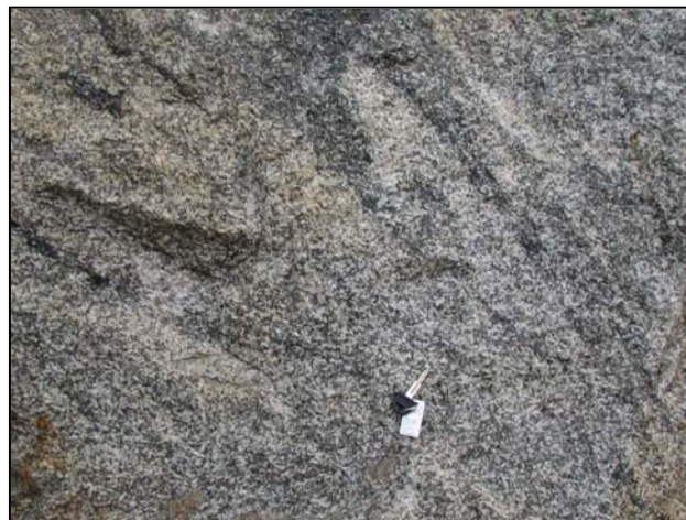
Fotografía 4.3.2.8.23.- Detalle textural de la roca explotada en Granitos del Noroeste. jfs
