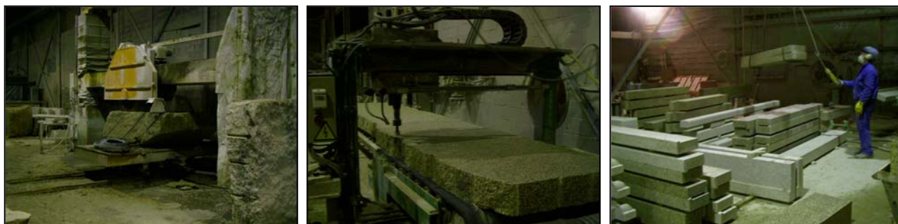
Fotografía 4.2.5.2.9.- Distintos aspectos de la elaboración de semibloques: Corte con sierra circular, abujardado y traslado de piezas en la nave con puente grúa. afa
