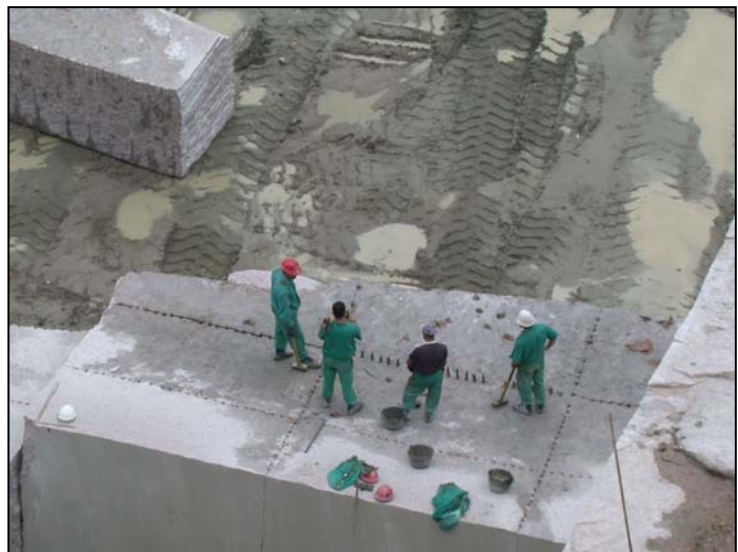
Fotografía 4.2.5.3.2.- Subdivisión del bloque primario utilizando perforación y cuñas accionadas manualmente con mazos. afa
