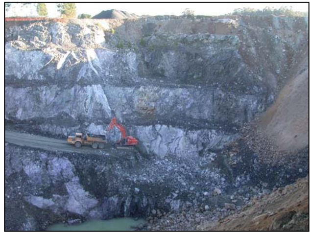
Fotografía 4.3.2.9.5.- Extracción de serpentinitas del hueco principal de la explotación Cuatro Amigos. jfs
