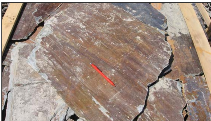
Fotografía 4.2.6.4.1.- Detalle de la intensa crenulación de las pizarras en Folgueiras. afa
