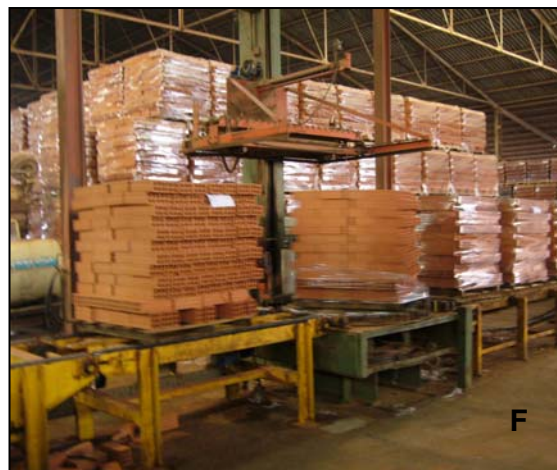
Fotografías 4.4.1.4.1.- A- Entrada del material al molino. B- Acopio de material en los pudrideros. C- Fabricación y corte de ladrillos. D- Vagonetas con ladrillos, previo a la cocción. E- Compuerta de entrada de las vagonetas. F- Plástico de los palés de ladrillos. G- Almacén de palets en una nave para su posterior distribución. jfs
