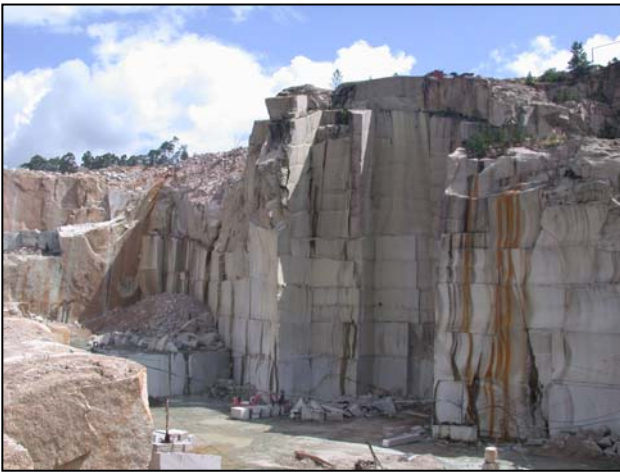
Fotografía 4.2.5.3.6.- Frente de cantera en la que se han realizado cortes con distintos métodos: Lanza y corte con hilo en la parte baja. afa
