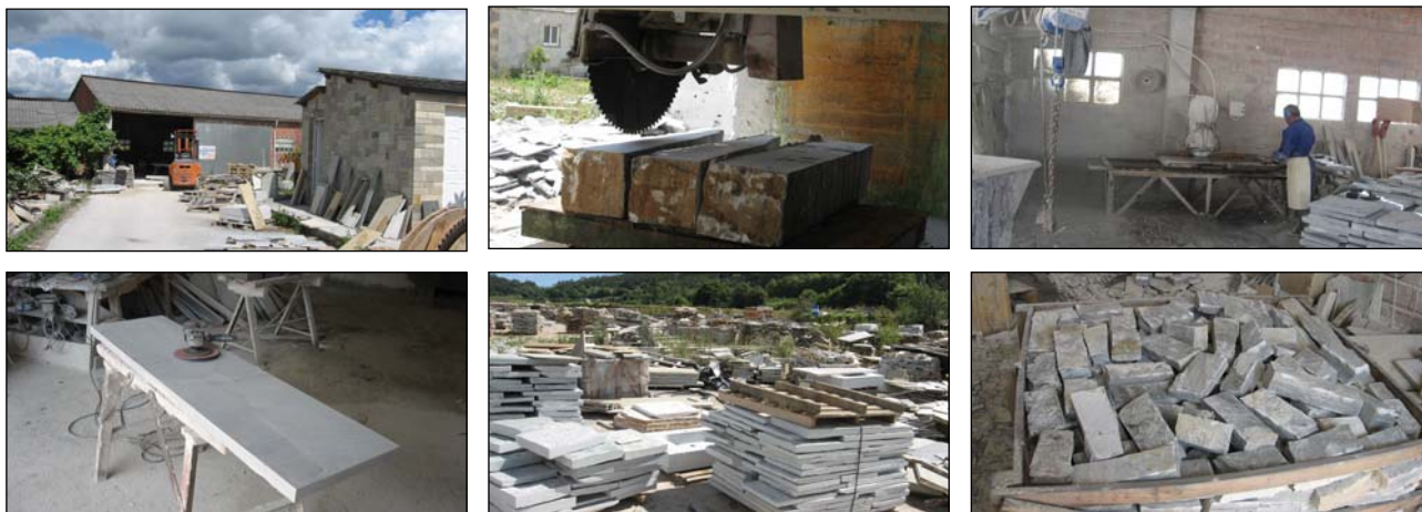
Fotografía 4.2.1.1.2.- Taller de elaboración de calizas– Serrado de bloques – Serrado de planchón- Pulido manual – Baldosas – Adoquines. afa
