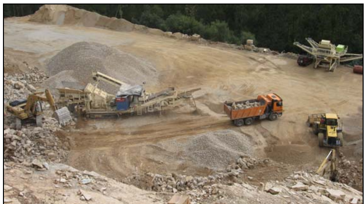
Fotografía 4.3.2.10.3.- Planta de tratamiento móvil en una cantera de áridos calizos. jfs
