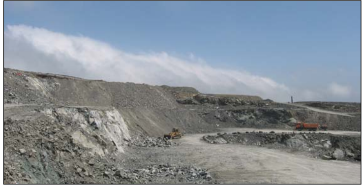
Fotografía 4.3.2.10.1.- Vista de los bancos donde se ha "tamizado" por volcado al banco inferior. afa
