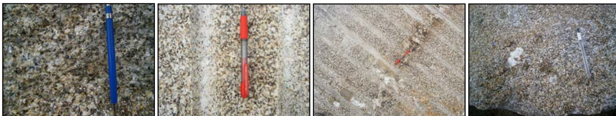
Fotografía 4.2.5.2.6.- Aspectos de detalle de la variedad “Pedra do País” en corte fresco y corte alterado y con una vena aplítica. “Silvestre moreno” en corte alterado. afa
