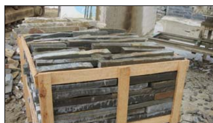
Fotografía 4.2.2.2.10.- Detalle de las capas en Folgueirosa – Corte con disco – Palet de tiras cortadas. afa
