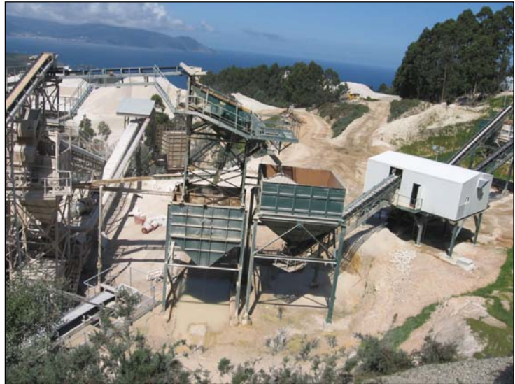
Fotografía 4.4.3.3.1.- Planta de tratamiento. El módulo (blanco) de la derecha es del Mikrosort). afa
