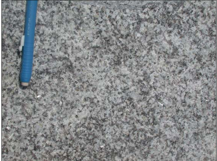
Fotografía 4.3.2.8.20.- Aspecto textural del granito explotado en el Macizo de Orro. afa
