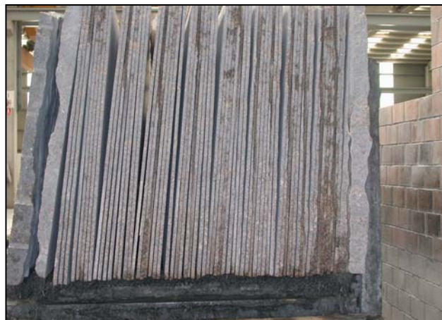
Fotografía 4.2.5.3.13.- Bloque cortado en telar en tableros de 2 cm de grosor. afa
