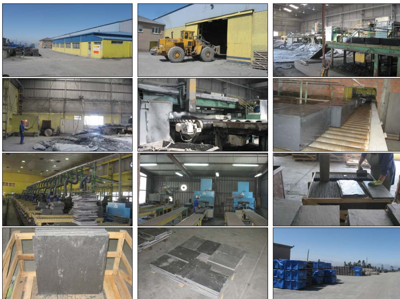
Fotografía 4.2.6.13.6.- Distintos aspectos del proceso de elaboración de la pizarra para cubiertas (y suelos) (de izquierda a derecha y de arriba abajo): Planta de tratamiento – Entrada de rachón – Nave de serrado – Colocación del rachón con puente grúa – Detalle del serrado del rachón – Transporte del “tocho” a la nave de labrado – Puestos de labradores – Cortadoras eléctricas – Embalaje –Placas para cubierta – Placas para suelos – Palets de productos plastificados. afa
