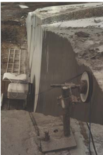
Fotografía 4.2.5.3.4.- Corte en cantera con hilo diamantado y detalles del corte con lanza térmica e hilo. afa
