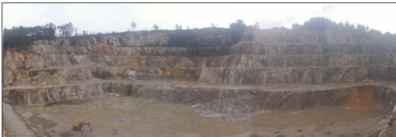
Fotografía 4.3.2.8.2.- Aspecto de una cantera de áridos de machaqueo en la facies Gris Mondariz, en el Macizo de O Porriño. vgs
