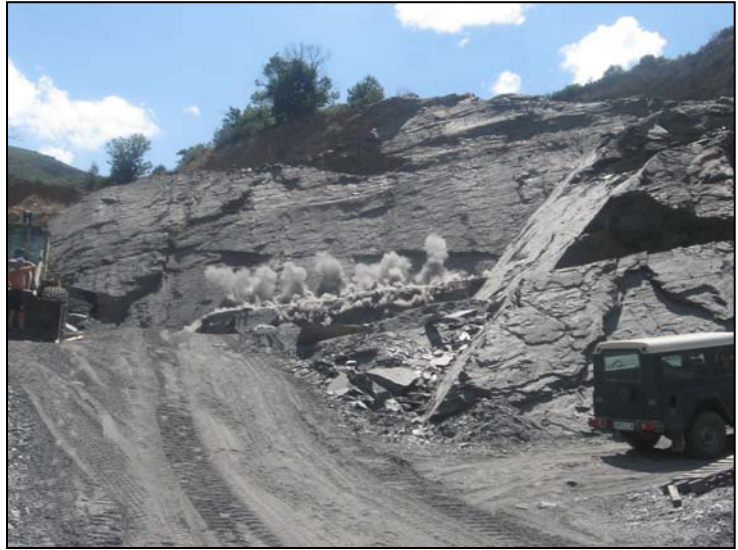
Fotografía 4.2.6.13.2- Pequeña voladura para arrancar el bloque primario. afa
