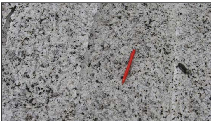
Fotografía 4.2.5.1.24.- Detalle textural del granito extraído en Os Agros, en el Macizo de A Toxiza. afa
