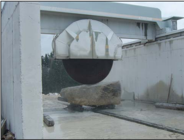
Fotografía 4.2.5.3.8.- Cortabloques monodisco gigante. jfs.
