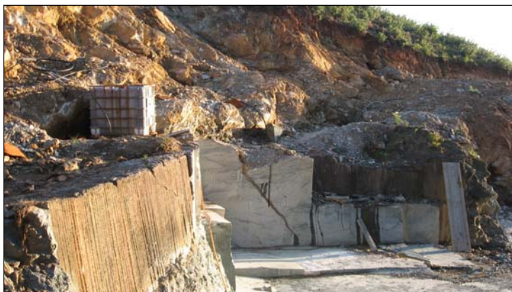
Fotografía 4.2.8.2.- Detalle del frente en Vizoso: corte antiguo (perforación) y actual con hilo.
