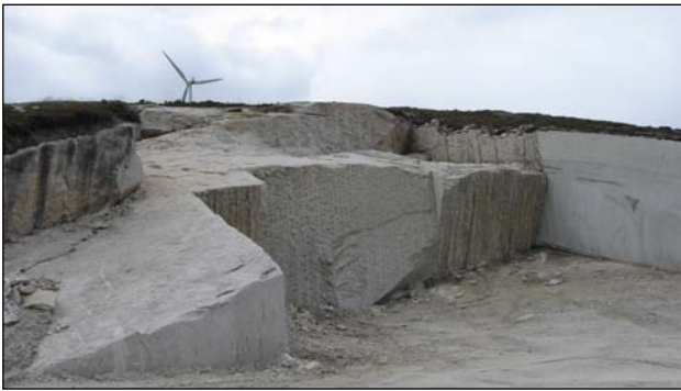
Fotografía 4.2.5.1.25.- Cortes con hilo diamantado en el frente bajo en Os Agros. afa
