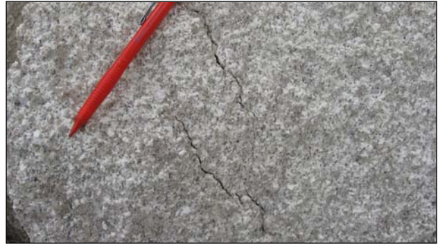
Fotografía 4.4.2.1.4.- Detalle del granito caolinizado en el frente de Gela. afa
