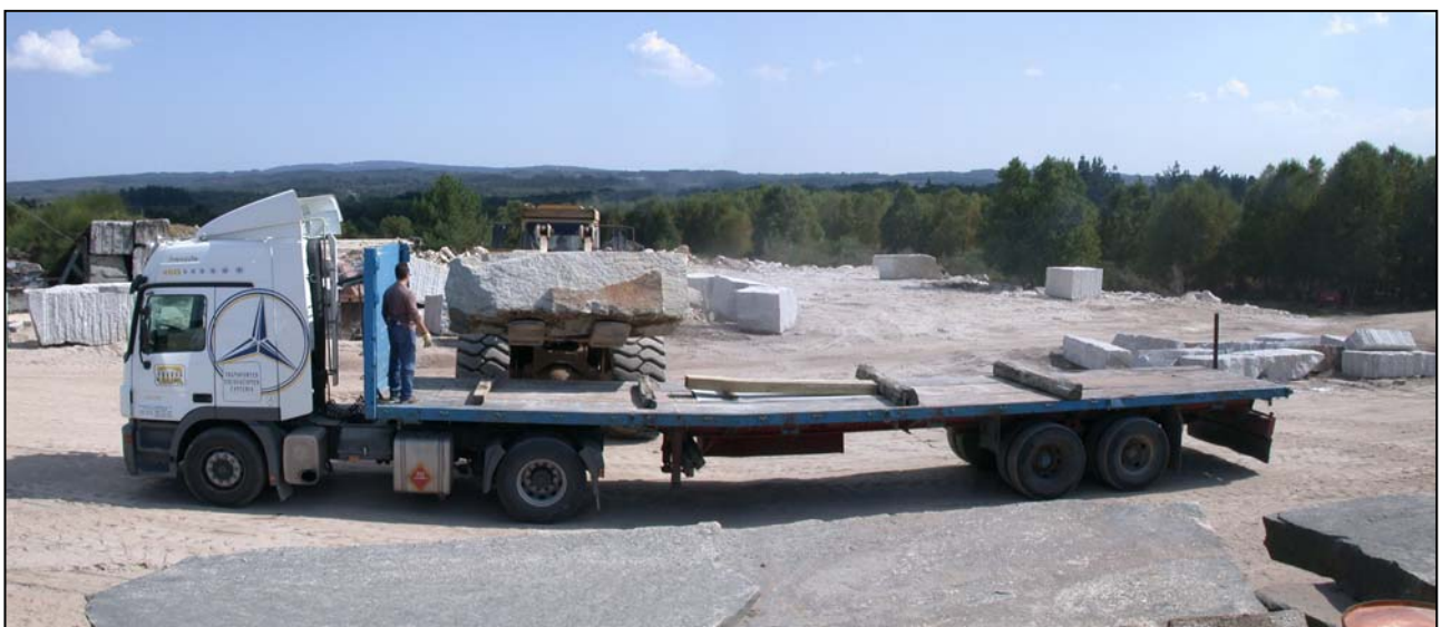
Fotografía 4.2.5.3.7.- Carga de bloque en cantera para su transporte. jfs
