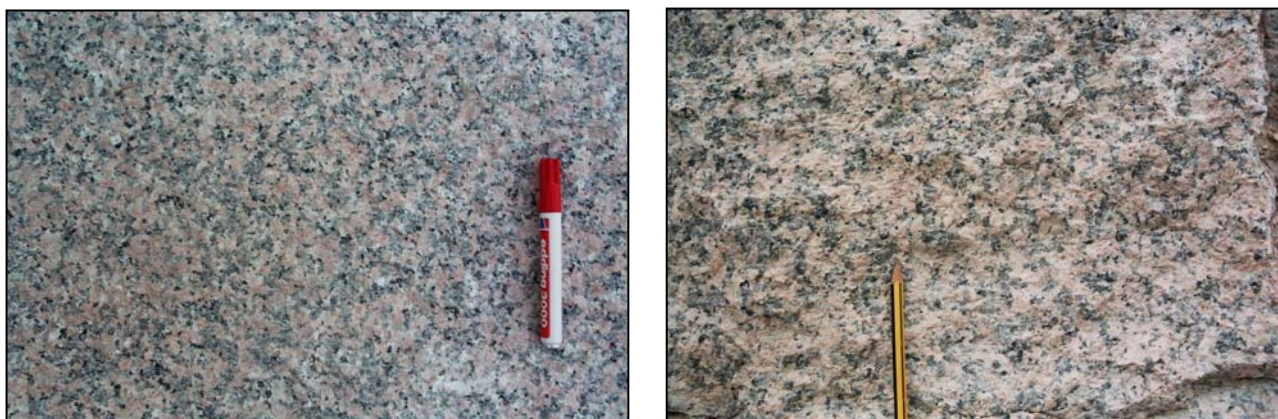
Fotografía 4.2.5.1.1.- Aspectos texturales de granitos de grano muy grueso y color rosado, tipo "Rosa Porriño". afa
