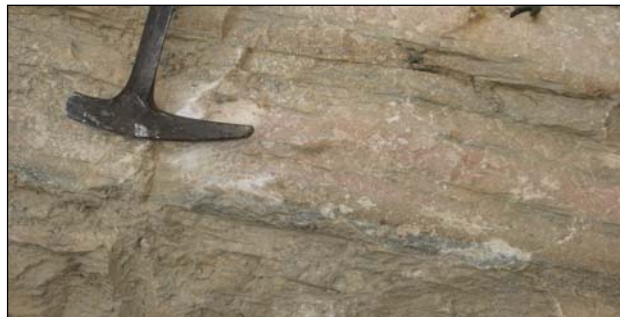
Fotografía 4.2.1.4.- Detalle de la caliza blanca con niveles de color rosa (Cantera Trinidad). afa
