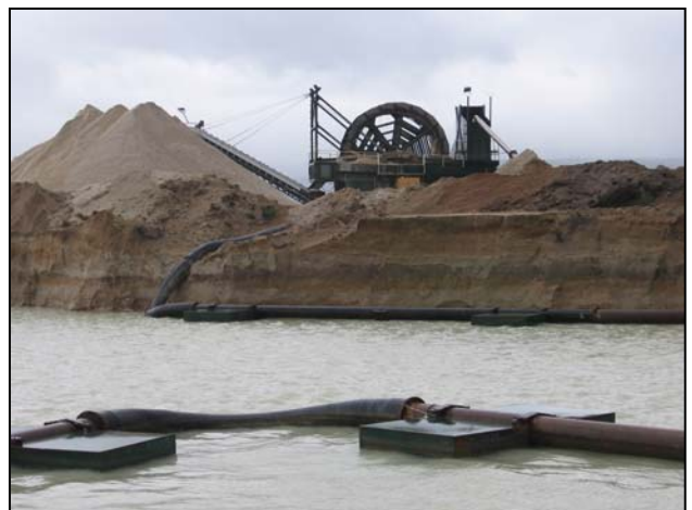
Fotografía 4.3.1.1.4.- Draga y noria de lavado para la obtención de arenas bajo el nivel freático en Xinzo de Limia. afa
