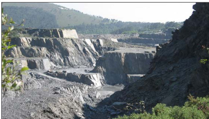
Fotografía 4.2.6.7.1.- Aspecto de un frente con pizarra de buena calidad en el sector de Monte Rande. afa
