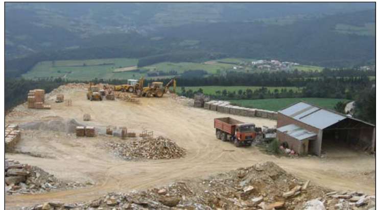
Fotografía 4.2.2.2.8.- Aspecto de la plataforma de elaboración y de stock de productos y nave de protección de maquinaria y personal (Cantera Marisol). afa
