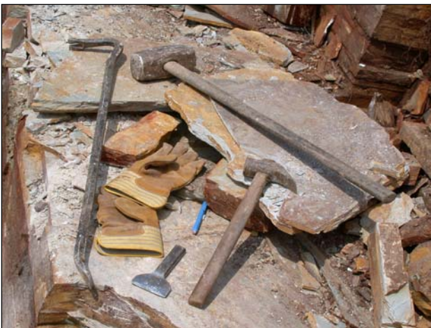
Fotografía 4.2.2.8.2.- Herramientas para el trabajo de exfoliación y desbaste en canteras de cuarcita.
