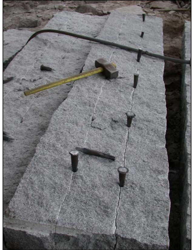
Fotografía 4.2.5.3.5.- Obtención de perpiaño de forma manual con pinchotes y mazo. jfs
