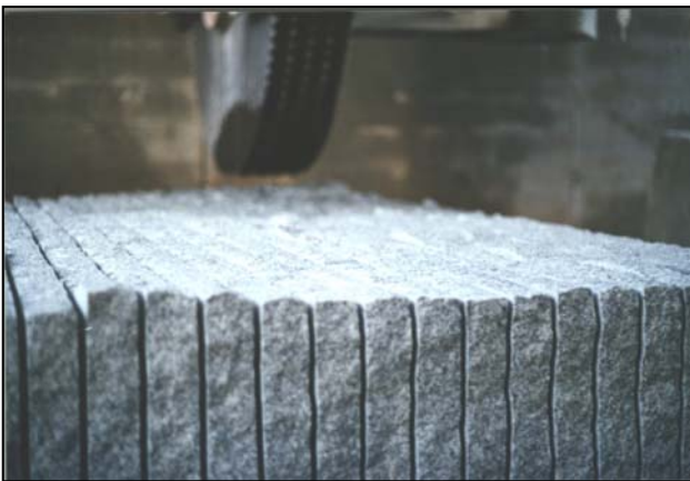
Fotografía 4.2.5.3.11.- Sierra multidisco para obtener placas gruesas. afa
