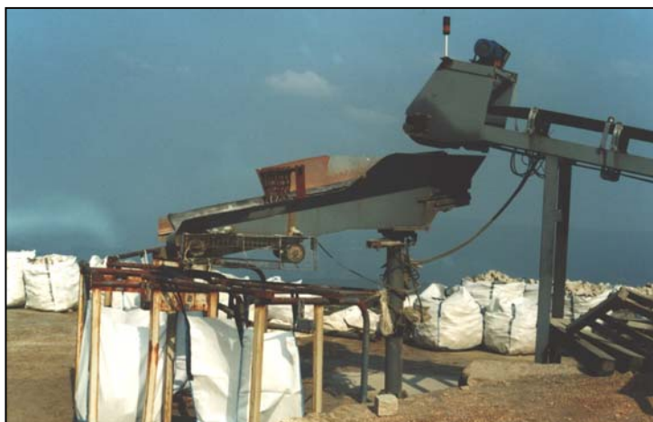
Fotografía 4.2.5.2.5.- Ensacado automático de adoquines. afa
