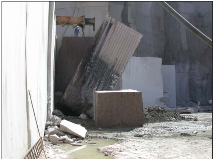
Fotografía 4.2.5.3.3.- Volcado de un gran bloque sobre “cama” de tierra para evitar roturas. afa
