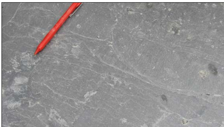
Fotografía 4.2.6.3.6.- Superficie de pizarra que muestra la lineación de intersección (hebra). afa
