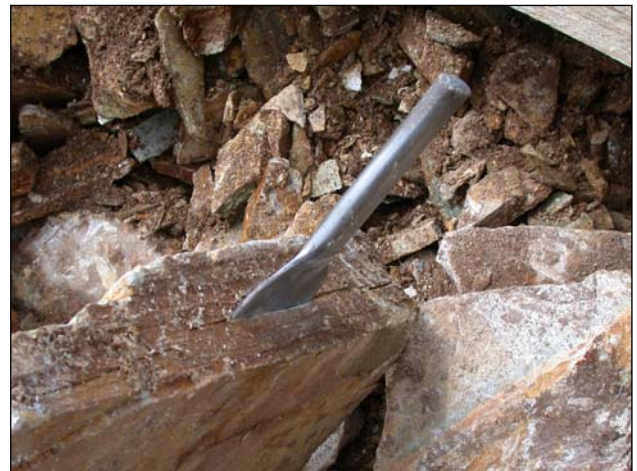
Fotografía 4.2.2.8.2.- Herramientas para el trabajo de exfoliación y desbaste en canteras de cuarcita.
